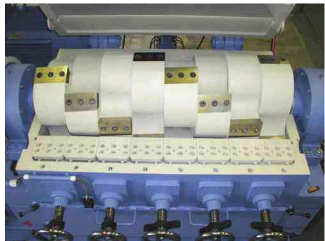
Blick in den Mahlraum eines Granulators der Baureihe HGM
